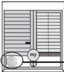
Sensor solar orientado para o exterior
